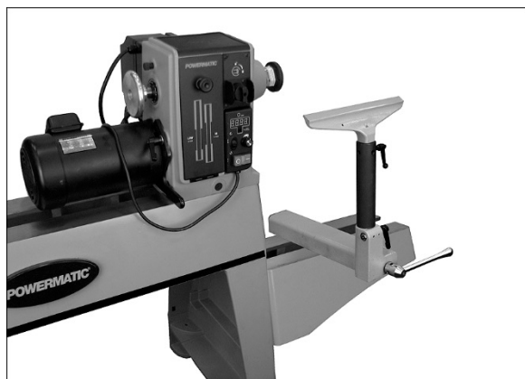
Рис. 6-7: принадлежности для точения вне станка
