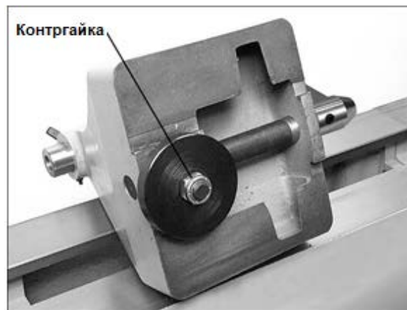
Рис. 8-2: регулировка зажимного эксцентрика
