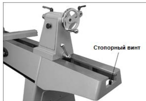
Рис. 6-6: дополнительное удлинение станины на 508 мм
